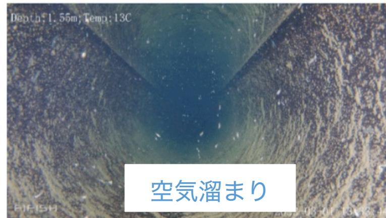
管内部にカキ類等の貝類や、ヒトデ類等の付着生物が確認されたが、個体数は少数であった。自然海水管と比較し、管内部に汚れの付着が多く見られたが、着水槽内、管内部共に堆積物は確認されなかった。また、管内に空気溜まりが多く確認された。これらのことから、付着生物や堆積物等による通水の障害は生じていないと考えられる。
