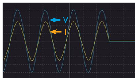
電圧源遮断試験
