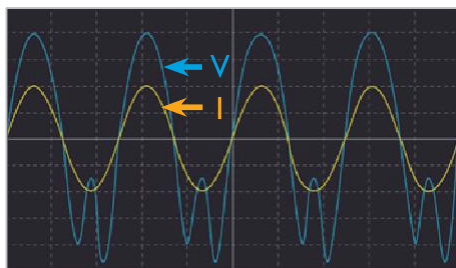
スローモードは歪んだ電圧源に対して高い許容性を提供します
