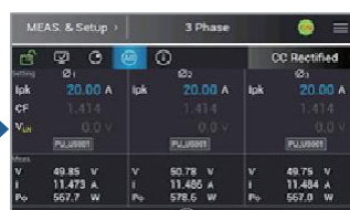
PUモードでは、ピーク電流をユーザーが設定できます
