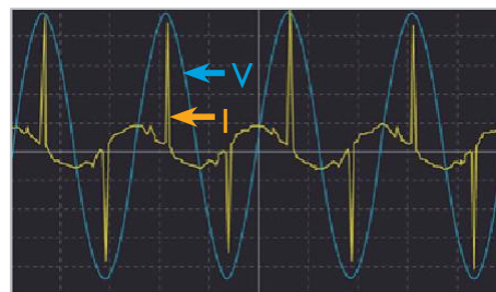
ファストモードは高い電流制御精度を提供します
