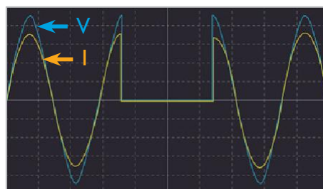
CRモードにおける電圧遮断負荷試験
