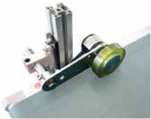
エンコーダー 印字物の加減速に追従する ためのパルス信号を出力
